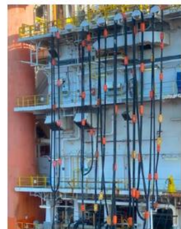
Figura 16 – Exemplos de estações de recebimento, Fonte: empresas Seadrill e Etesco
