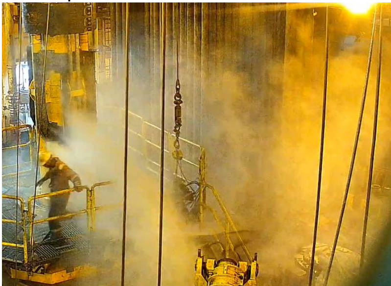
Figura 26 - Exemplo de rompimento e chicoteamento de mangueira hidráulica, Fonte: empresa Seadrill
