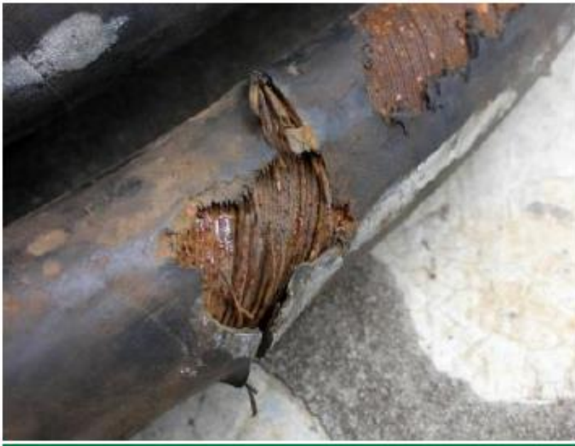
Figura 20 - Exemplo de mangueira com desgaste na cobertura
