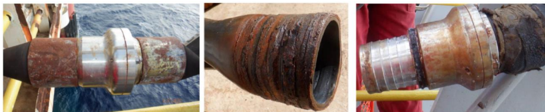
Figura 23 - Desconexão da válvula breakaway durante transferência de cadit, Fonte: empresa Ventura
