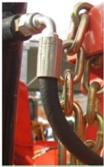
Ressecamento da cobertura
