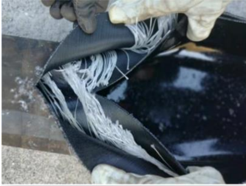
Figura 22 - Rompimento de mangote durante recebimento de diesel, Fonte: empresa Foresea
