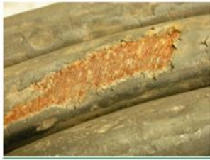
Abrasão na cobertura da mangueira
