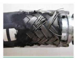
Prensagem excessiva da conexão
