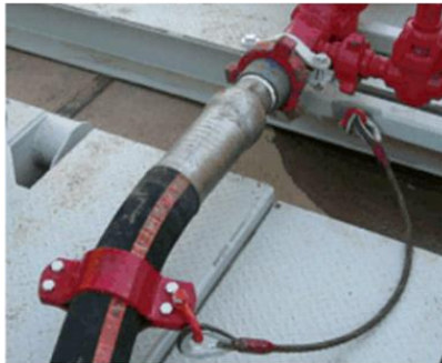
Algema de segurança do tipo "HOSE HOBBLE" com uso de linga de cabo de aço.
