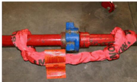
Algema de segurança do tipo "HOSE HOBBLE" com uso de cinta têxtil.
