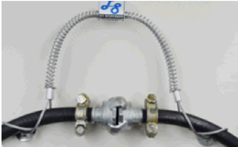
Figura 10: Exemplo de instalação adequada de algema de segurança
