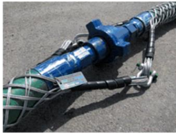
Algema de segurança do tipo "WHIP STOP ou WHIP SOCK".
