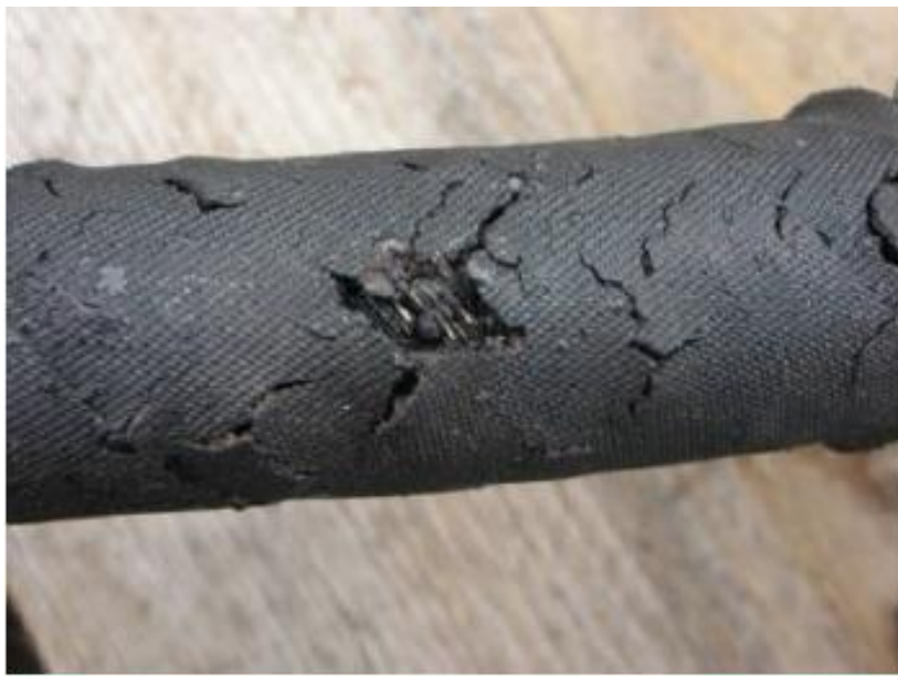
Figura 21 - Exemplo de mangueira com enrijecimento
